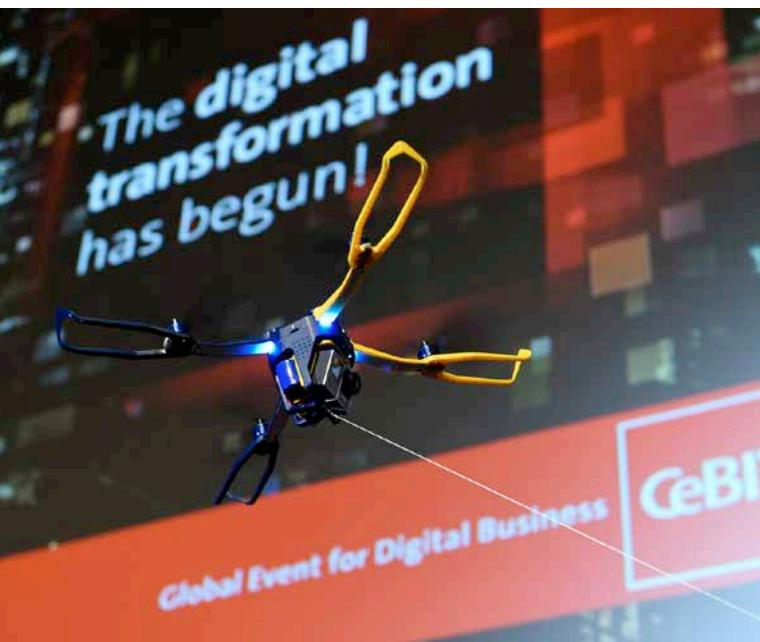
Das ETH-Zürich-Spinoff Fotokite zeigt ein Fluggerät mit einem 30 Meter langen Kabel, das sich ähnlich einfach und sicher steuern lässt wie ein Flugdrachen. Dank der Leine wurde das Gerät als erster Flugroboter von der Federal Aviation Administration (FAA) in den USA für Flüge über größeren Menschenmengen zugelassen.
