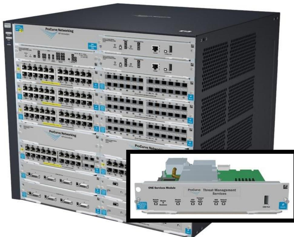
Mit dem neuen HP TMS z1 Modul können HPs Switch-Serien 8212 und 5400 um Firewall-, VPN- und IPS-Funktionalität erweitert werden.
