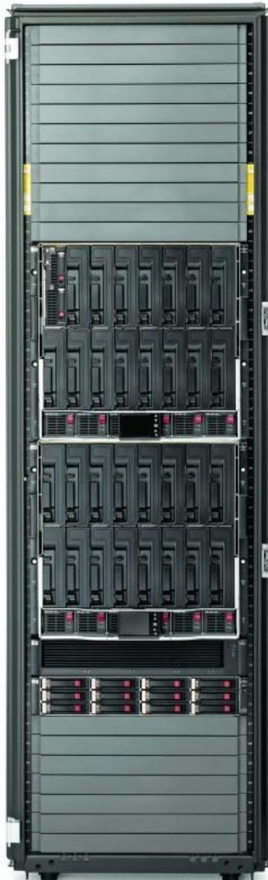
So kann die Hardware-Seite der Lösung aussehen: HP BladeSystem Matrix mit HP ProLiant Server BL460c G6 und HP StorageWorks 4400 EVA im HP-BladeSystem-c7000-Enclosure.
