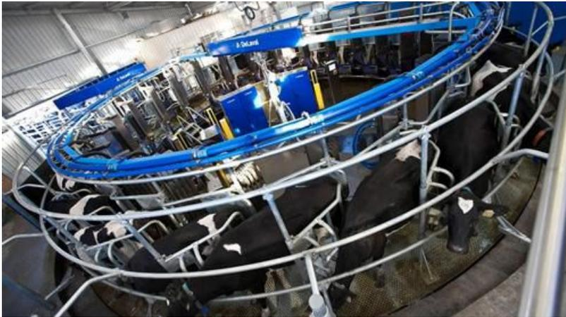
Das Produktsortiment von DeLaval reicht vom Melken über die Milchkühlung bis zur Fütterung und Entmistung. Das Bild zeigt ein automatisches DeLaval-Melkkarussell. Foto: DeLaval
